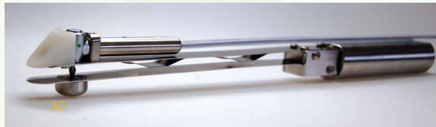
< Afb 1: Het eerste prototype van de flexibele, gehoekte craniotoom voor het optimaliseren van de endoscopische behandeling van craniosynostose
